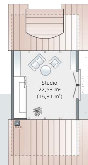
Niedrigenergiehaus Obergeschoss Plan 1111.5 DN 38°, KN 125 cm 60,51 m² nutzbare Grundfläche 54,88 m² Wohnfläche Maßstab 1:100
